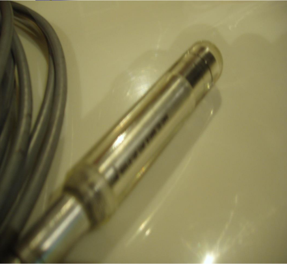
Silindirik iyon odası (Buildup cap'li) Farmer Tipi 0.6 cc NE
