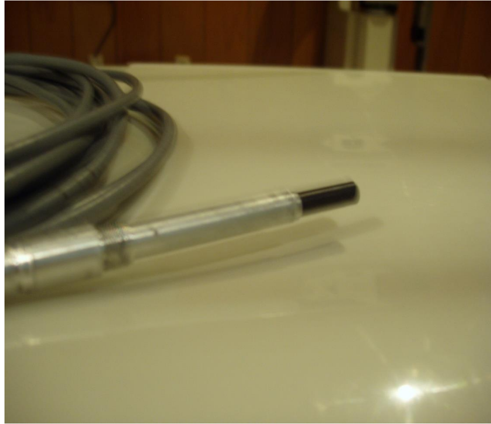
Silindirik iyon odası (Buildup cap'siz) Farmer Tipi 0.6 cc NE
