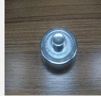
Şekil 2. Mentor marka geçici doku genişletici içerisinde bulunan Samaryum Kobalt (SmCo) magnet ve paslanmaz çelikten oluşan metalik port
