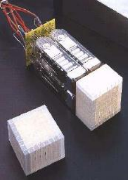
Metalik özellikte PMT ve LSO kristal bağlantısı
