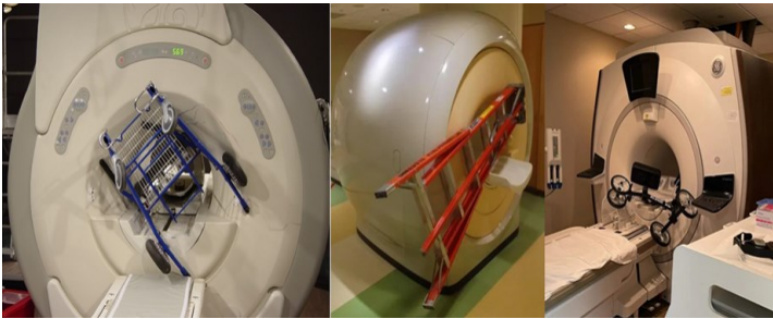
Şekil-2: MR uyumlu olmayan cihazlar ve kaza örnekleri.
