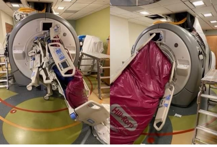
Şekil-1: MR uyumlu olmayan hasta yatağının magnet tarafından yakalanması.
