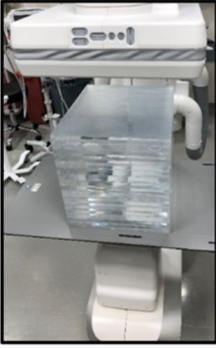
Şekil 12. Görüntü kalitesini değerlendirmek için kullanılan PMMA fantomlar
