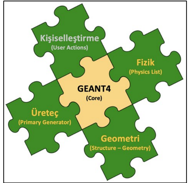
Şekil 2. GEANT4 kullanımında temel gereksinimler (Turuncu renkle gösterilenler zorunlu tanımlanması gereken parametreler – Gri renkle gösterilenler isteğe bağlı parametreler)
