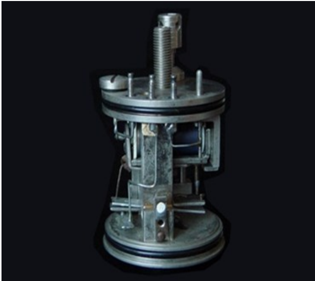
Şekil 1: 1919 Fizik Profesörü Wilhelm Hammer'ın Elektrostatik röle icadı, bunu sayesinde çok Düşük elektrik yükleri hassas bir şekilde ölçülmeye başlandı.
