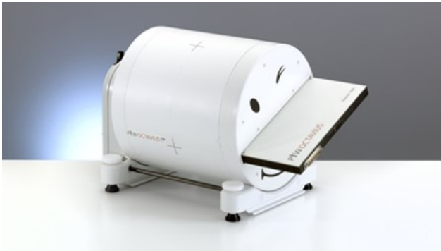
Şekil 14: Octavious 4D ilk defa Gantry ile senkronize şekilde dönerek 3 boyutlu doz ölçebilen sistem
