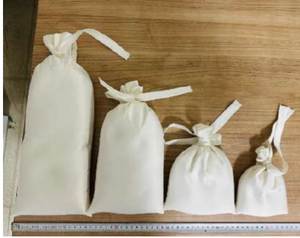
Şekil 2: Doz modülasyonu için kullanılan farklı kalınlık ve yoğunluklara sahip pirinç torbaları.
