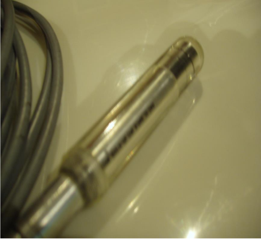
Silindirik iyon odası (Buildup cap'li) cap'siz) Farmer Tipi 0.6 cc NE
