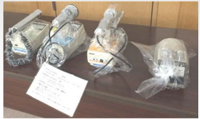
Şekil 2: Acil durum kullanımı için hazırlanmış radyasyon ölçüm cihazları. Soldan sağa: sintilasyon probu; alfa parçacık yüzey kontaminasyon dedektörü; Geiger-Müller ddektörü, iyonizasyon odası.
