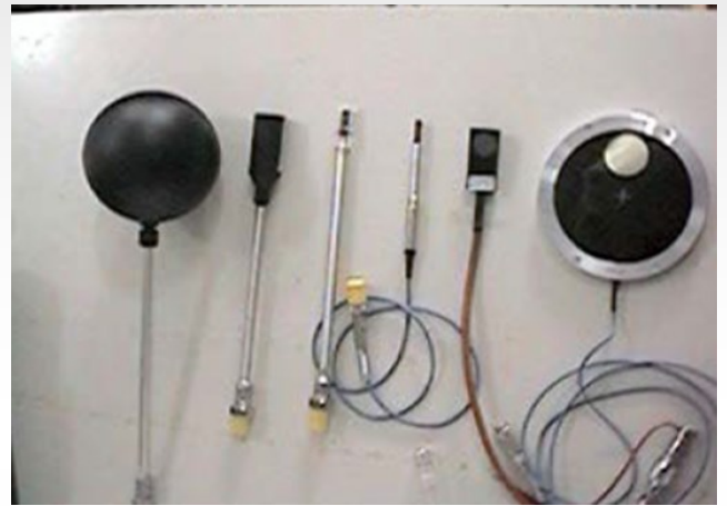
Resim 5: SSDL kullanılan çeşitli bazı iyon odaları
