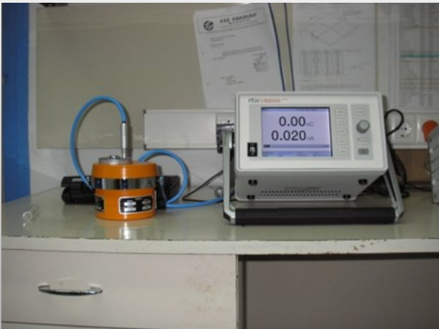
Resim 9: PTW Webline İkinci Derecede Standart Tedavi Düzeyli Dozimetre
