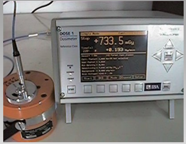
Resim 10: Wellhoffer İkinci Derecede Standart Tedavi Düzeyli Dozimetre
