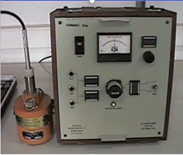
Resim 7: NPL İkinci Derecede Standart Tedavi Düzeyli Dozimetre
