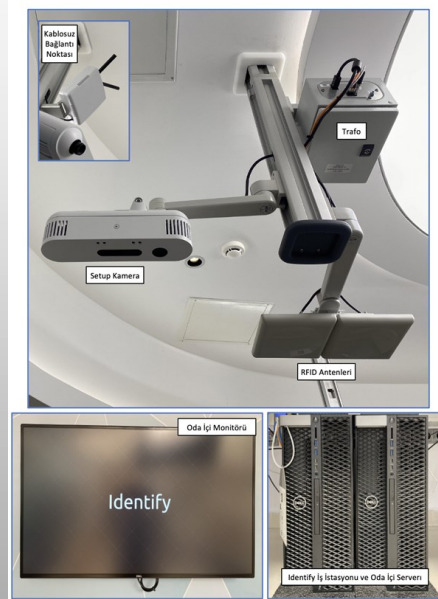
Şekil 2. Setup Kamera Sistemi, Oda İç Monitör, Çalışma İstasyonu ve Oda İç Server Sistemi
