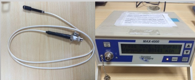
Resim 3: Extradin-A18Ref 92729 marka iyon odası ve Standart Image-Max4000 elektrometre
