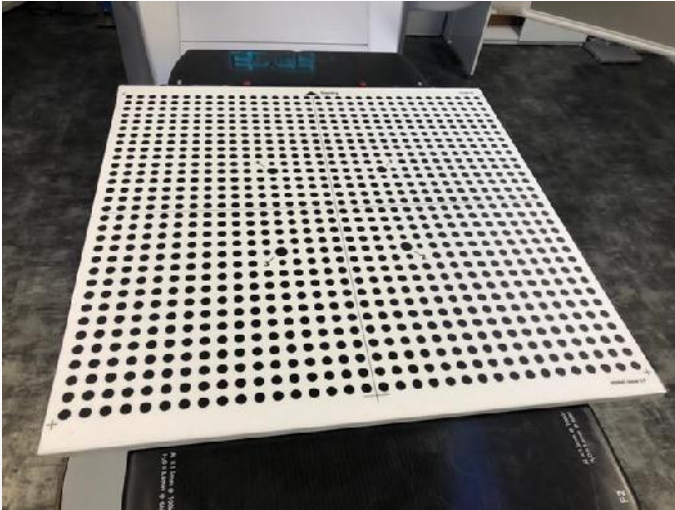
Şekil 8. Günlük ve Aylık kamera kalibrasyonunda kullanılan kalibrasyon düzlemi.
