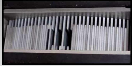
Şekil 2: Tomotherapy H serisi MLC yapısı
