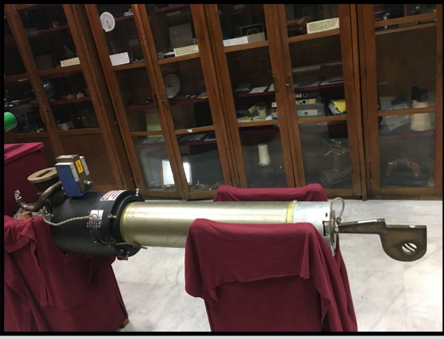
Resim 15b: Türkiye’de ilk kullanılan Lineer hızlandırıcı, siemens Mevatron XII (x,e-) cihazı hızlandırıcı tüpü
