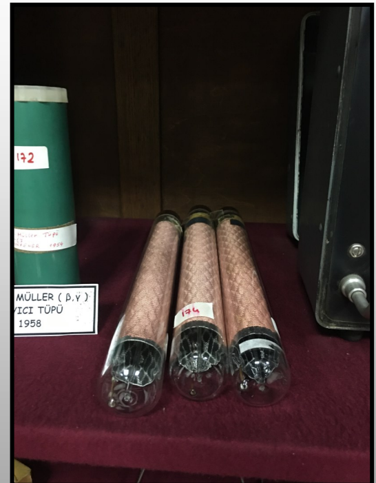
Resim 10b: Gayger Müller ( \beta , g) sayıcı tüpü
