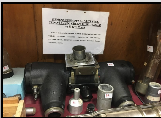
Resim 9d: Siemens Dermopan-1 yüzeysel tedavi x-ışını cihazı tüpü
