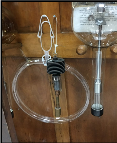
Resim 6e: Neon-Helium gazlı deşarj tüpü (Dairesel)
