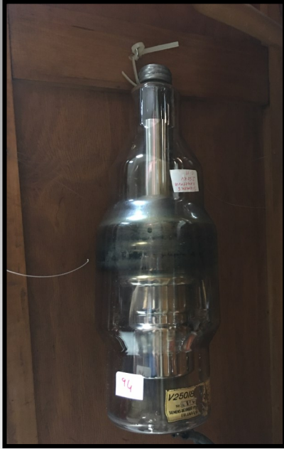
Resim 9a,b: Teşhis ve tedavi tüpleri, siemens kenetron (1948-sonrası).
