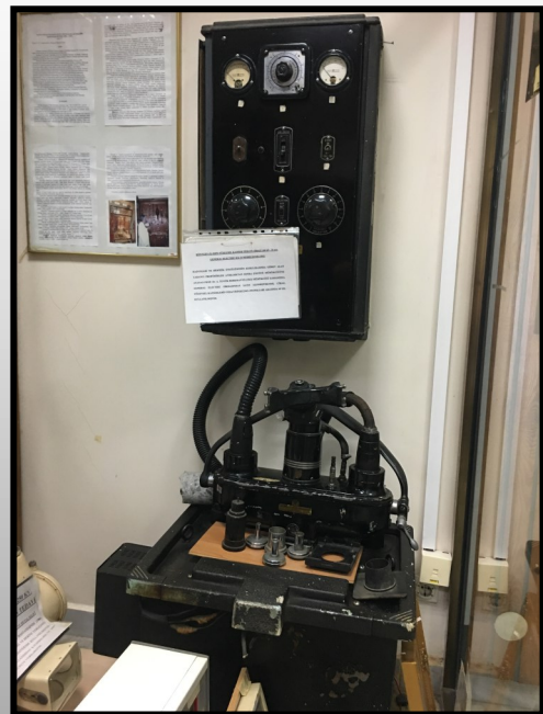
Resim 15a: General Elektrik KX-10 model 140 kV, 10mA yüzeysel tedavi cihazı ve kontrol paneli
