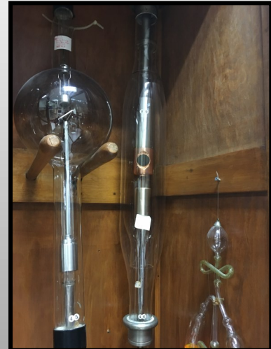
Resim 7a,b,c: Tanı ve tedavi cihazlarına ait Röntgen tüpleri (1933-1948).
