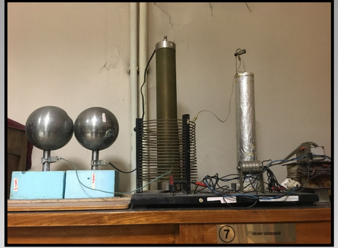
Resim 11g: N.Tesla transformatörü ile katot ışını elde etmek için kullanılan deney seti
