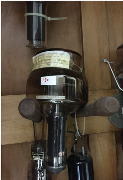
Resim 9a,b: Teşhis ve tedavi tüpleri, siemens kenetron (1948-sonrası).
