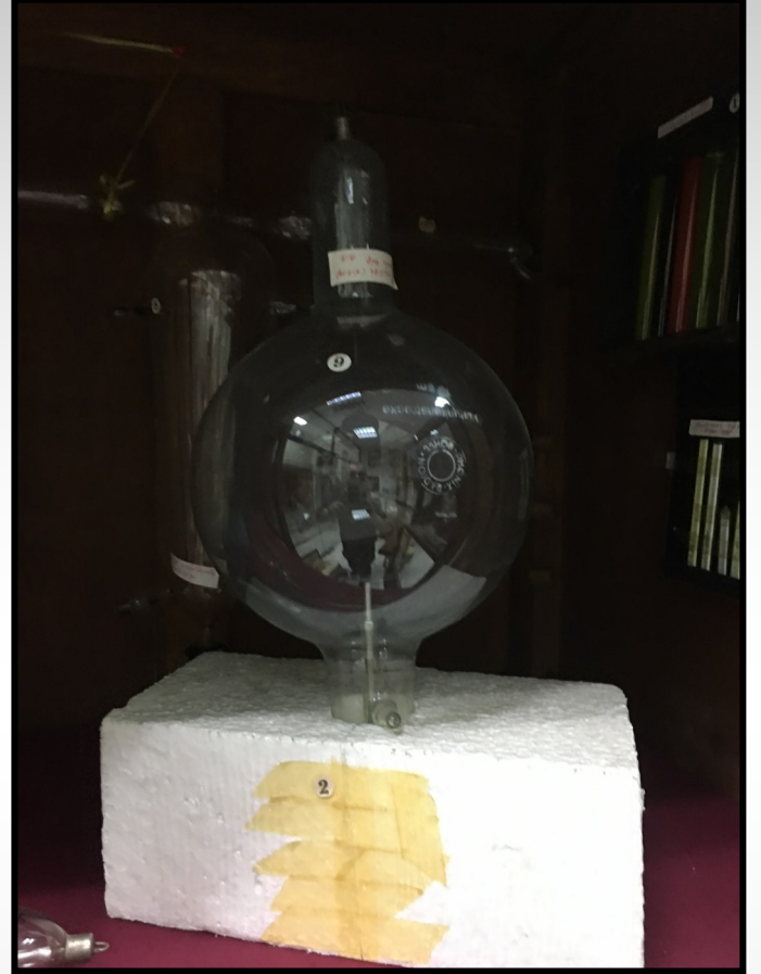
Resim 5c: Katot ışını crookes tüpü fluorescent materyali
