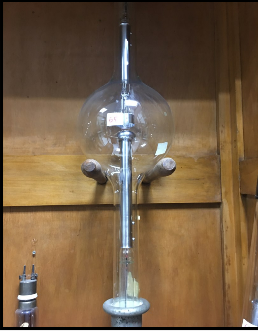
Resim 6c: Colidge Röntgen tüpü (1927-1930)
