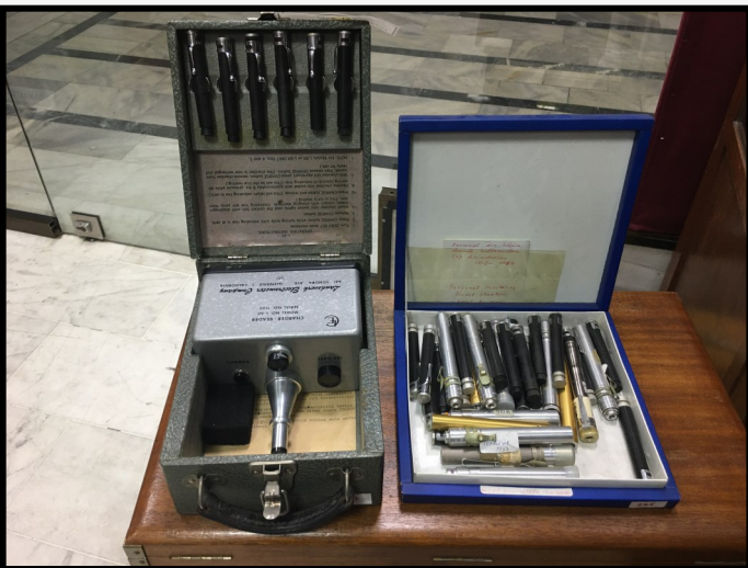
Resim 13c: Kişisel kalem dozimetre ve elektrometre
