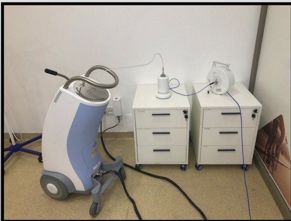
Resim 3: Kuyu Tipi İyon Odası Aktivite Ölçüm Düzeneği
