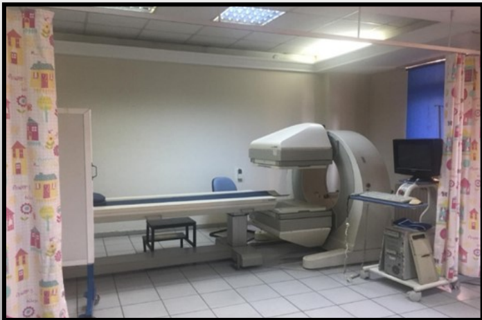
Resim 1: Mediso Marka çift detektörlü gama kamera. Ağırıklı olarak Tc-99m ile işaretlenmiş radyofarmasötiklerin sintigrafik görüntülemelerinde kullanılmaktadır.
