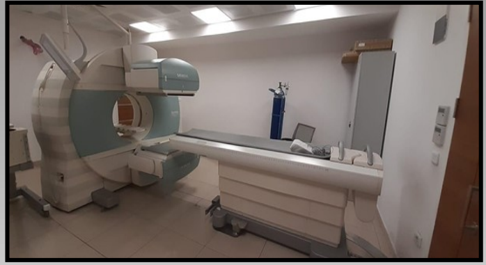
Resim 2: Siemens Marka 16 slice SPECT/BT cihazı. Radyonüklid tedavi öncesi ve sonrası, Tc-99m ile işaretlenmiş radyofarmasötiklerin sintigrafik görüntülemelerinde kullanılmaktadır.
