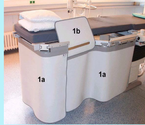
Şekil 1. a) Masa etrafına monteli optimize edilmiş X ışını tüpü radyasyon zırhı b) hastadan saçılan radyasyon zırhı
